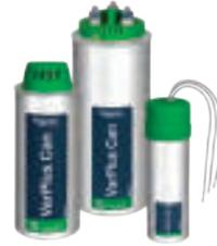
Los Condensadores trifásicos de potencia para BT, Varplus Can Heavy Duty están especificados para aplicaciones altamente exigentes, incluso en ambientes contaminados por armónicos hasta un 20% (NLL < 20%), pueden soportar trabajos en sobrecorriente hasta 1.8 In en régimen permanente y su alta expectativa de vida (130,000 horas) los hacen los condensadores mas rentables del mercado.
