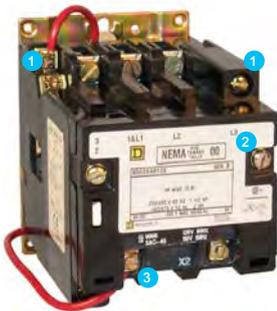
Los contactores 8502S se utilizan para conmutar cargas de calefacción, capacitores, transformadores y motores eléctricos. Están disponibles en tamaños NEMA 00 a 7. Fueron diseñados para funcionar en tensiones de hasta 600 VAC.
